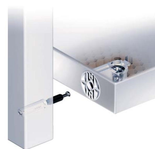
7 + 8 Möbel mit Mehrwert: Der unsichtbare Klebedübel für Leichtbauplatten „hettinject VB insert“ wurde mit einem Verbindungsbolzen als neue „E-Variante“ so aufgebaut, dass er eine Spannung von 12 V DC übertragen kann. Diese Spannung reicht aus, um beispielsweise LED-Einbauleuchten über ein integriertes Kabel mit Strom zu versorgen. So kann moderne Technik in Möbelbauteile aus hohlkernigen Sandwichplatten integriert werden (Fotos: Hunger (l.), Hettich (o.))
