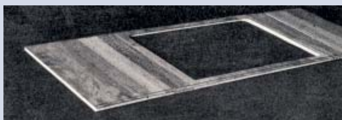
3 + 4 Gehäuse für Radio- und Fernsehgeräte wurden früher als echte Leichtbaukonstruktionen aus 4 bis 10 mm dünnen Sperrholzplatten in elegante Rundungen gebogen. Die Mantelfläche (o.) ist zum Biegen der Eckradien eingeritzt. Die Sperrholzplatten für kleinere Gehäuse wurden bereichsweise gedämpft und heiß gebogen. So entstand das Radiogehäuse links (Holzwirtschaftliches Jahrbuch, S. 80f [6])
